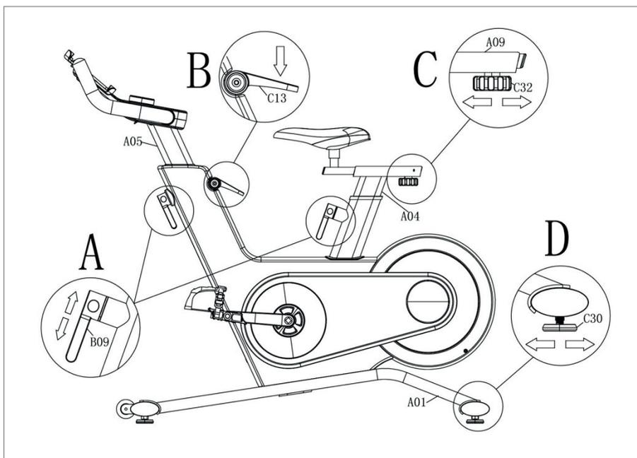
A. Поверните регулировочную ручку (B09) влево, чтобы отрегулировать высоту вертикальной стойки (A05) и стойки сиденья (A04), затем поверните ручку вправо, чтобы зафиксировать стойки на нужной высоте.
